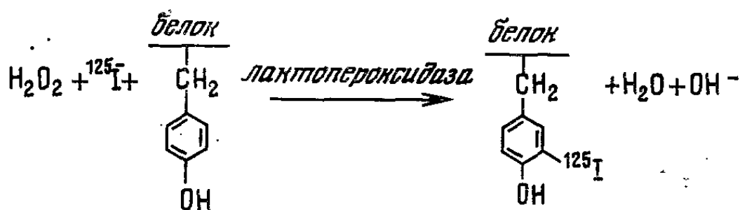
Рис. 3.8. Лактопероксидазный метод иодирования остатков тирозина в белках. Ферментативное иодирование затрагивает только поверхностные белки и поэтому может использоваться для локализации белков в клеточной мембране.
